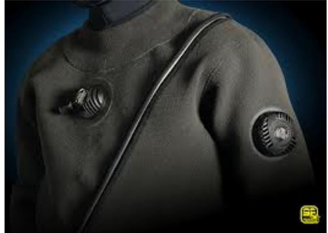
A la remontée l'air emprisonné dans la combinaison va augmenter de volume, modifiant le lestage du plongeur qui devient plus léger. Il faut donc, pour rétablir l'équilibre, laisser le surplus d'air s'échapper. C'est le rôle de la soupape.
